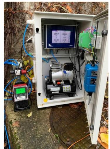
Nettoyage à l'acide phosphorique d'une sonde DCO UV dans une laiterie
