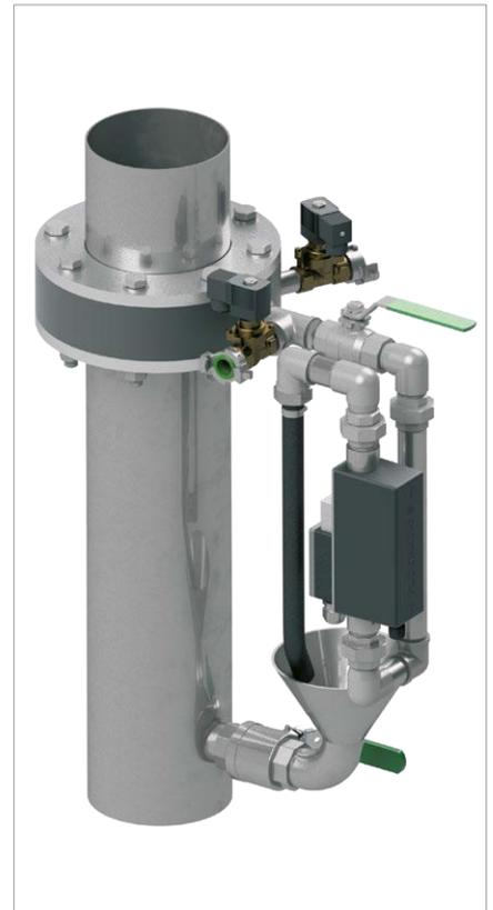
Mit der wartungsfreien **Flocmatic® Zentratwassersonde FMC2** ist es möglich, den permanenten Zentratwasserzustand zu überwachen. Der intelligente Regler bei etwaigen Veränderungen unmittelbar eingreifen. Dabei werden geringere Mengen Flockungsmittel benötigt und es kann ein stabilerer Betrieb bei gleichzeitig geringerem Bedienungsaufwand der Zentrifugenanlage erreicht werden.
