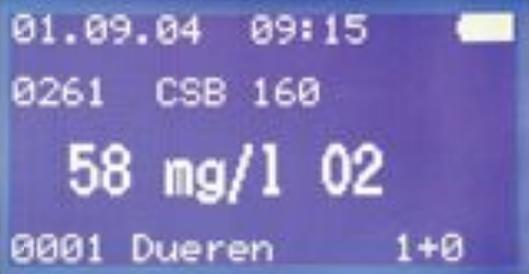
Messbereichsüber- oder -unterschreitungen werden angezeigt. Außerhalb des Messbereichs liegende Messwerte können zum Abschätzen der Verdünnung abgefragt werden.
